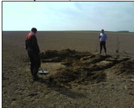
Photo 3. Recherche du lysimètre (tranchées + détecteur de métaux)
